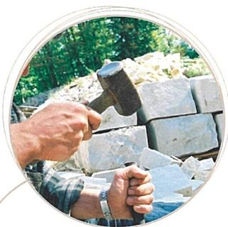
Les carriers utilisent des techniques traditionnelles : marteau à la main et coins à enfoncer dans la pierre, ils détachent les blocs des coteaux et taillent des pavés parfaits. Les outils, nécessaires à la fabrication des pièces de grès, sont encore de nos jours forgés par les carriers eux-mêmes ».
